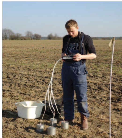
Messung der Ammoniakemission direkt nach der Düngung auf einer Versuchsfläche
