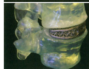
Bandscheibenprothese, TiAl6V4 (Quelle: Medical Modeling LLC, USA)
