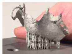
Kieferimplantat mit Stützstruktur, CoCr (Quelle: Econolyst Ltd., UK)
