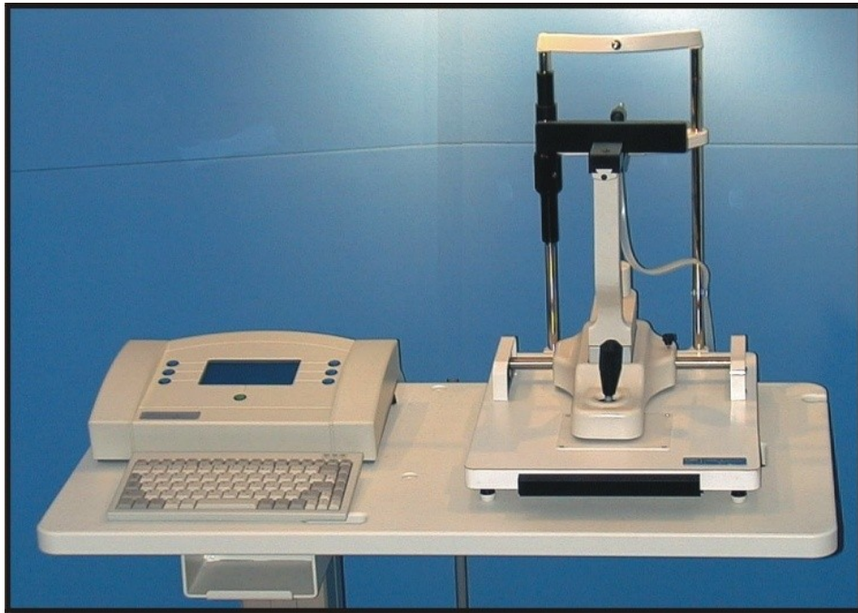
Abb. 35 Messtechnischer Aufbau des okulären Blutflusstonographen; Messgerät mit Messsonde, befestigt an einem Joystick-Kinnstützen-System [119].
