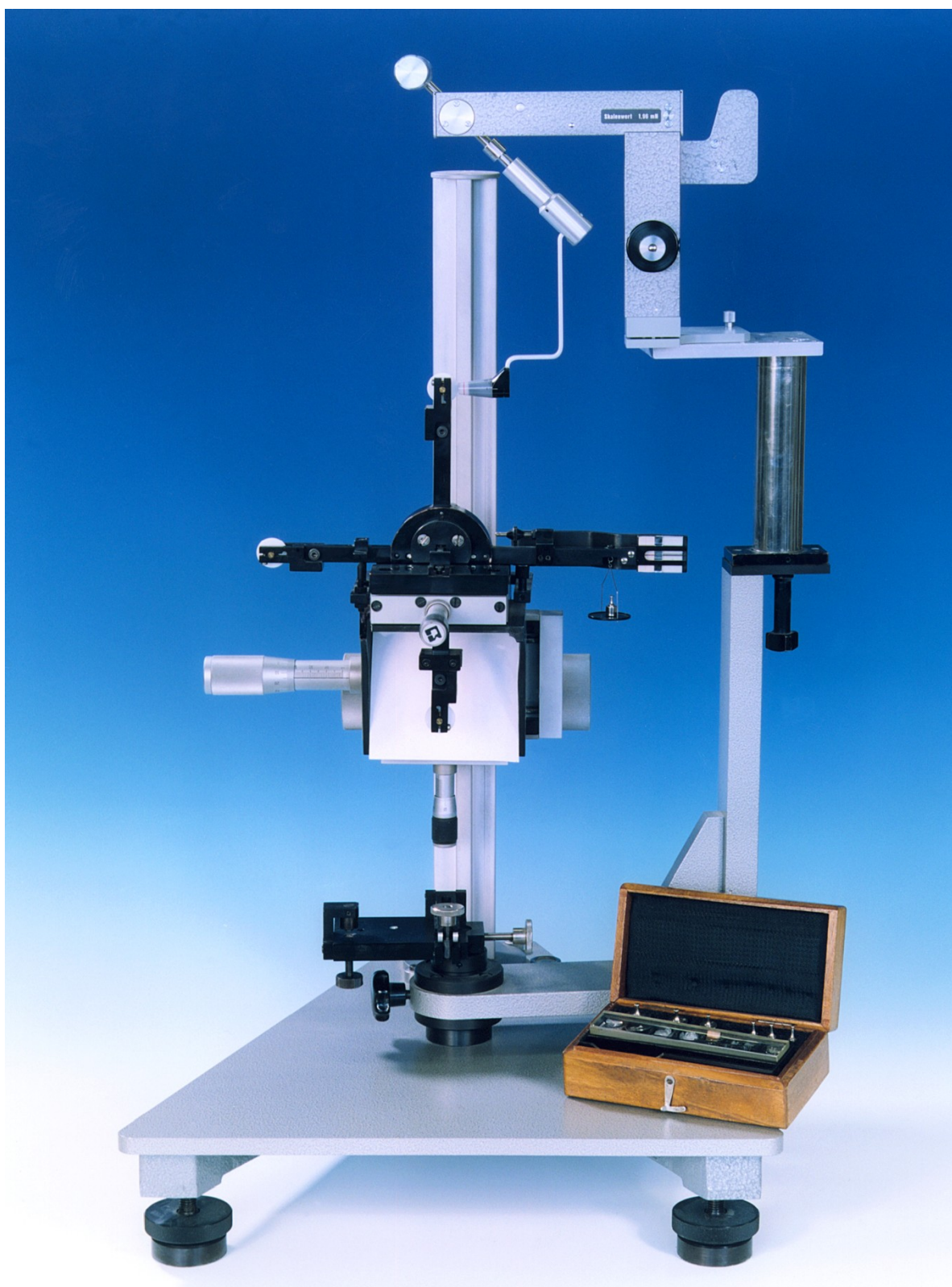
Abb. 40 Vorderansicht der Kreuzbalkenwaage mit dem Referenztonometer AT 870 und einem Satz Massestücken der Feingewichtsklasse F1 in Vorbereitung zur Kalibrierung.
