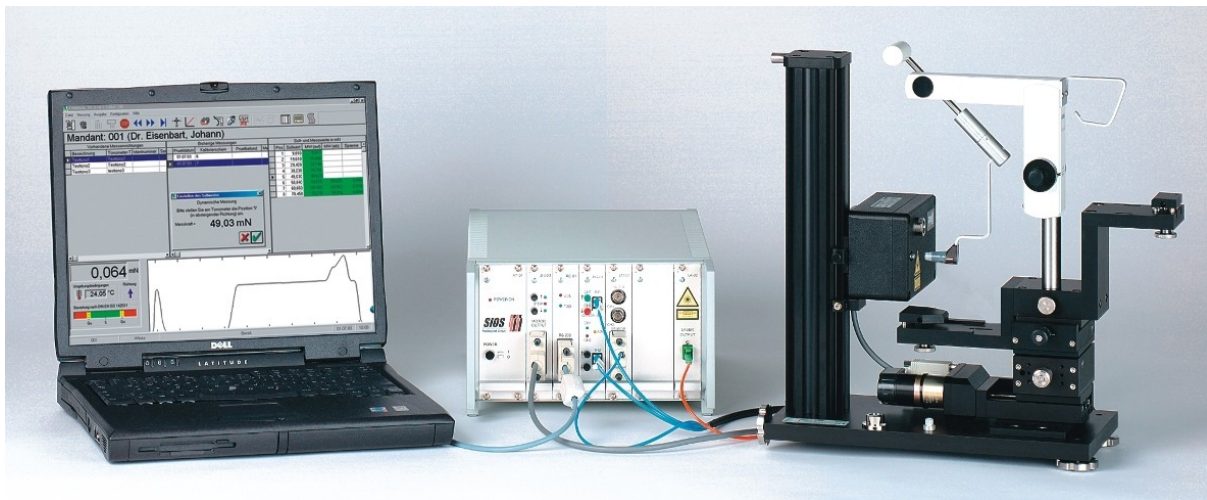
Abb. 42 Prüfeinrichtung (rechts) für Applanationstonometer der Firma mit dem Tonometer AT 870 beim Kalibrieren; links: Computer mit Messdatenanalyse-Software; in der Mitte: Messwertverstärker.
