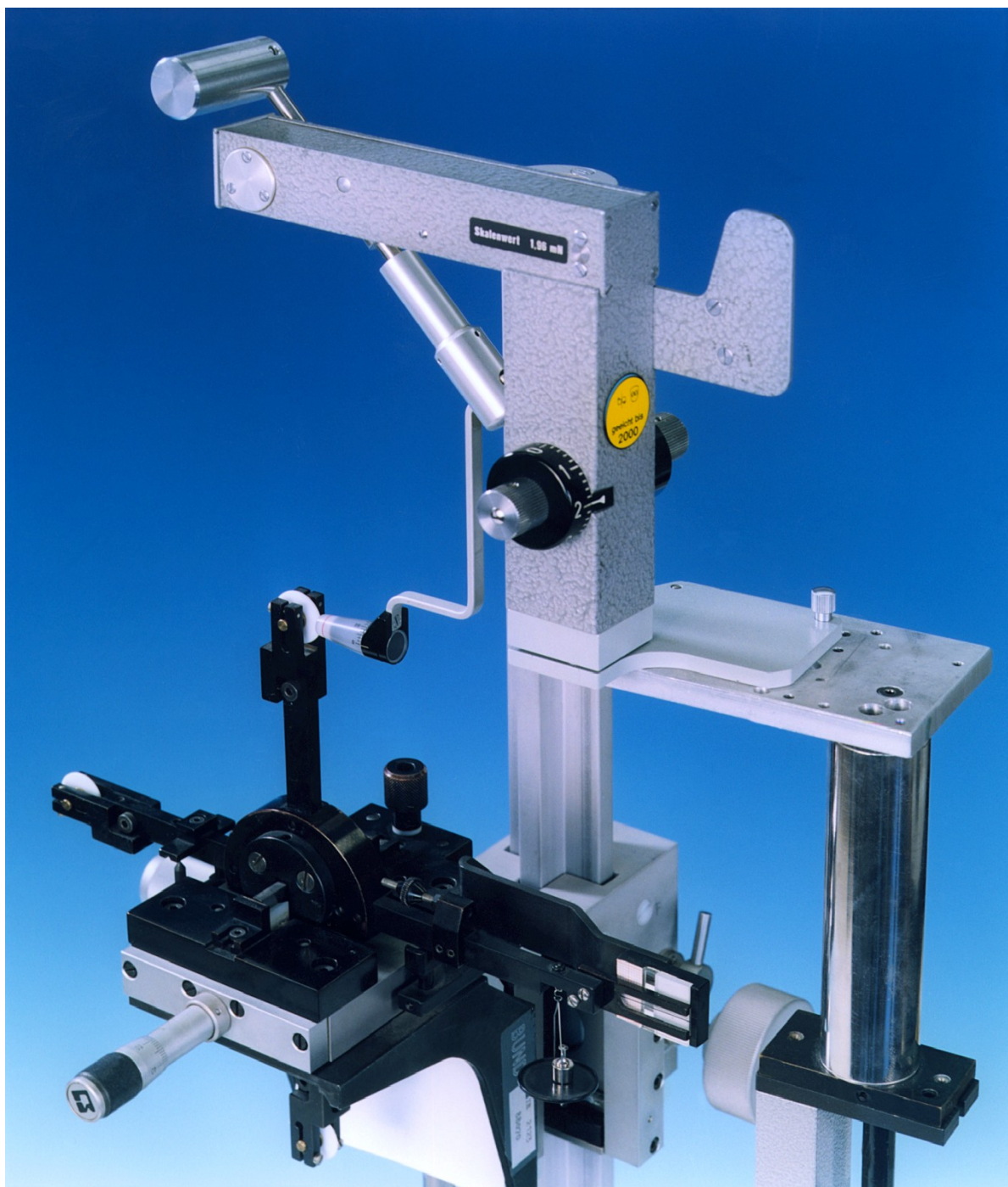
Abb.41 Messanordnung zum Bestimmen der mechanischen Kraft am Referenztonometer AT 870 in Perspektivdarstellung.
