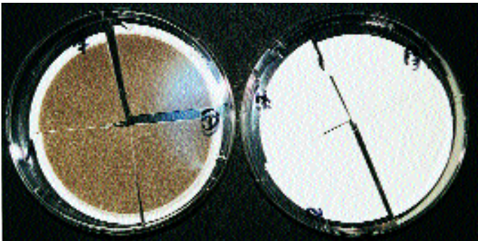
Abb. 6: Die für die Probenahmen verwendeten Gelatinefilter. Rechts ist ein nicht benutztes Filter zu sehen, links eines, durch das während simulierter Arbeitsaktivitäten in Kaiserslautern 1 m³ Luft gesaugt wurde
