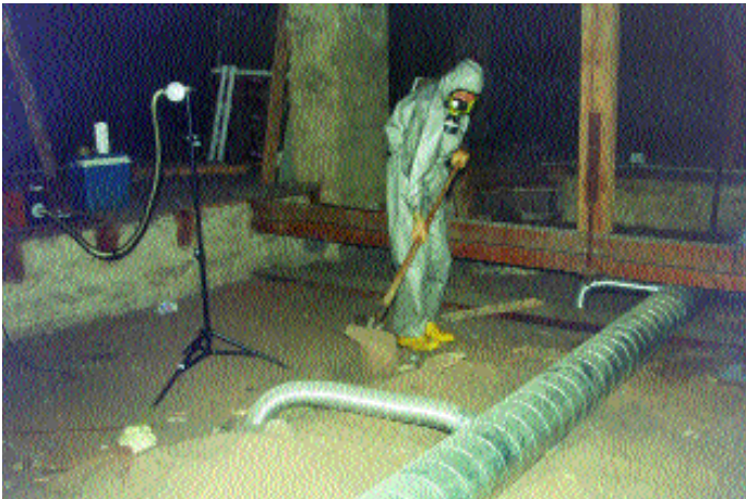
Abb. 5: Ehemals mit Taubenkot verunreinigter Dachboden in Kaiserslautern. Tauben hatten über Jahre ungehinderten Zutritt und verursachten sehr starke Verunreinigungen, die einige Monate vor der Probenahme entfernt wurden. Links im Bild ist das MD8-Probenahmesystem zu sehen. In der Mitte und rechts befindet sich fein gemahlener Flözsand, der zur Simulation von Arbeitsaktivitäten durch Schaufeln bewegt wurde.
