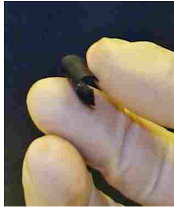
Abb. 3.8-3: „Papierbatterie“ aus Zellulose, Nanoröhren und flüssigen Salzen. (Quelle: Rensselaer-Institut; [Pushparaj, 2007a])
