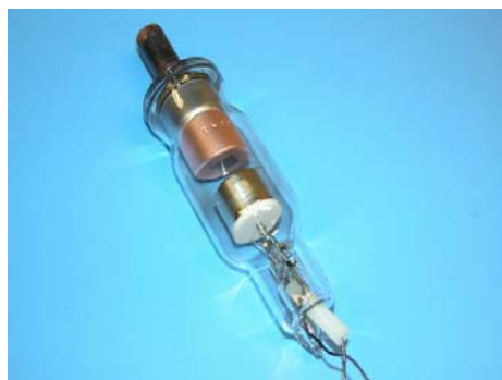
Abb. 3.2-4: CNT-basierte Feldemissionsröntgenröhre. (Quelle: http://xintek.com )
