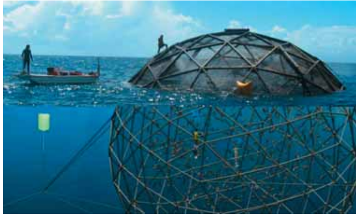
Abbildung 35: Frei im Meer treibende Kugeln aus Glasfaser und Polyethylen, gesteuert per Satellit und GPS - so könnte die Aquafarm der Zukunft aussehen. Aquapod™ Net Pens. Quelle: [Ocean Farm Technologies]
